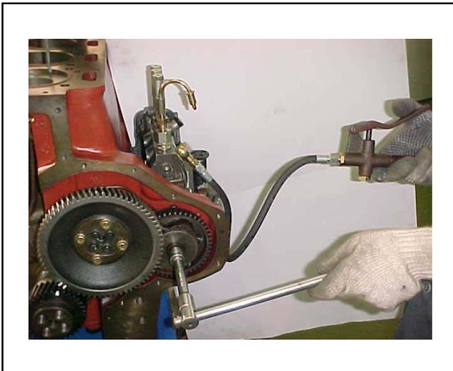
Bompear el combustible para la bomba hasta comenzar a salir combustible por el tubo gotejador. Virar simultáneamente el eje de la bomba en el sentido de rotación hasta observar que el combustible está saliendo de 2 a 4 gotas por minuto.
