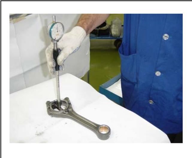
Montar la tapa de la biela sin los casquillos y aplicar aprieto especificado. Medir el diámetro interno, ovalización y conicidad.
