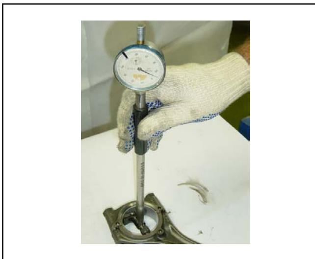
Con los casquillos debidamente montados y la tapa da biela instalada y apretada, efectuar la medición del huelgo radial.
