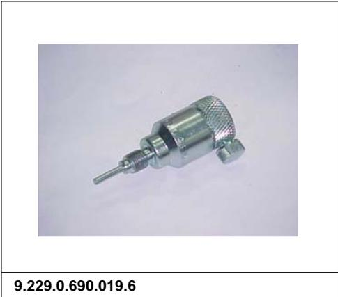
DISPOSITIVO P/ PUNTO DE INYECCIÓN DE LA BOMBA VE (8 MM)
