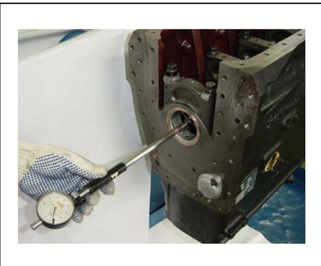
Posicionar el reloj del alesametro en el cero y conferir el hueco radial correspondiente al cojinete medido.
