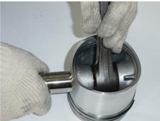
Instalar el pistón en la biela. El perno debe ser lubricado y montado solamente con la mano de manera suave, no debiendo ser empujado groseramente o batido con herramientas.
