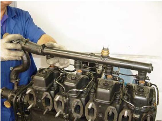
Instalar el tornillo del soporte del tubo de agua.
