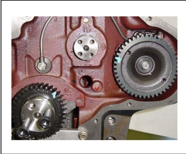
Con el engranaje instalado se debe observar la marca característica. Esta marca en el engranaje debe estar direccionada para el árbol de levas de las válvulas.
