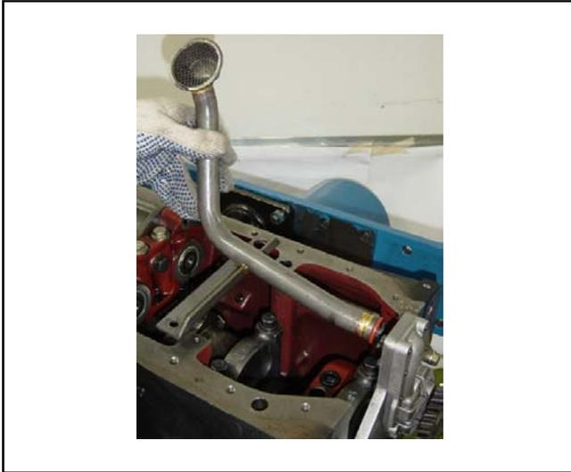
Instalar el tubo de succión de aceite y apretar los tornillos.
