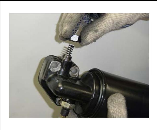
Efectuar el montaje de los demás componentes en el cuerpo de la válvula.
