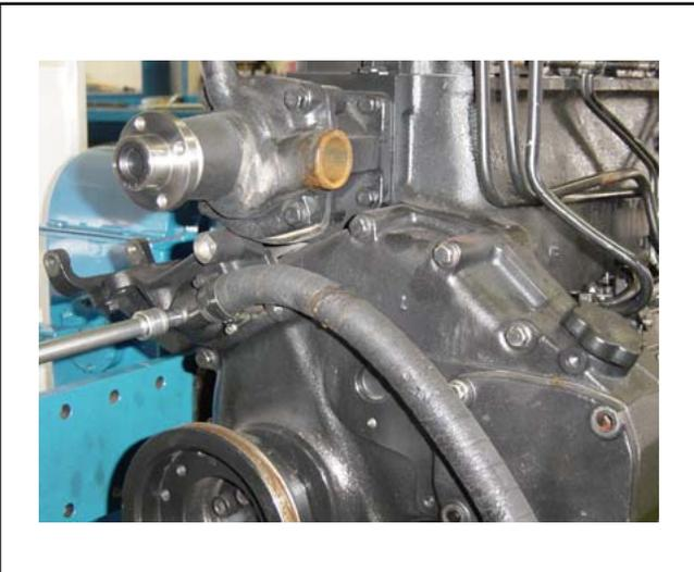
Soltar os parafusos e remover o respiro do motor e observar o seu estado quanto a limpeza e conservação.
