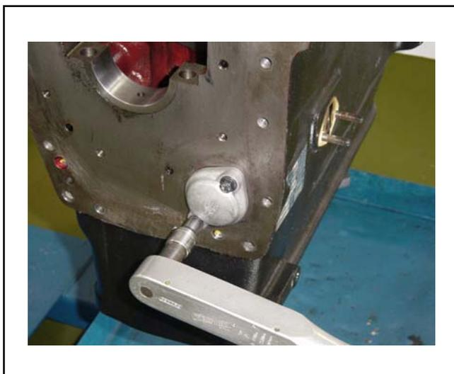
Para finalizar la instalación, se debe montar la tapa y aplicar el aprieto especificado.
