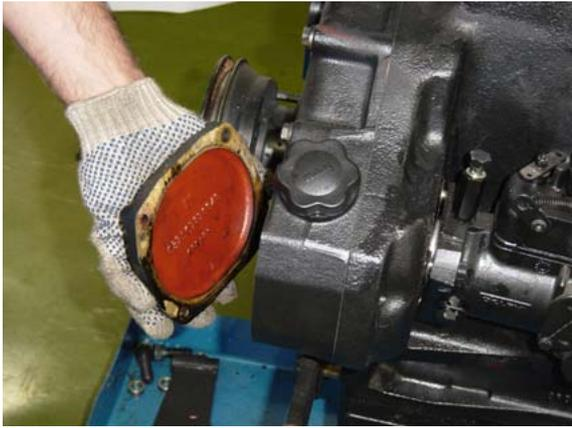
Soltar los tornillos y sacar la carcasa de los engranajes.
