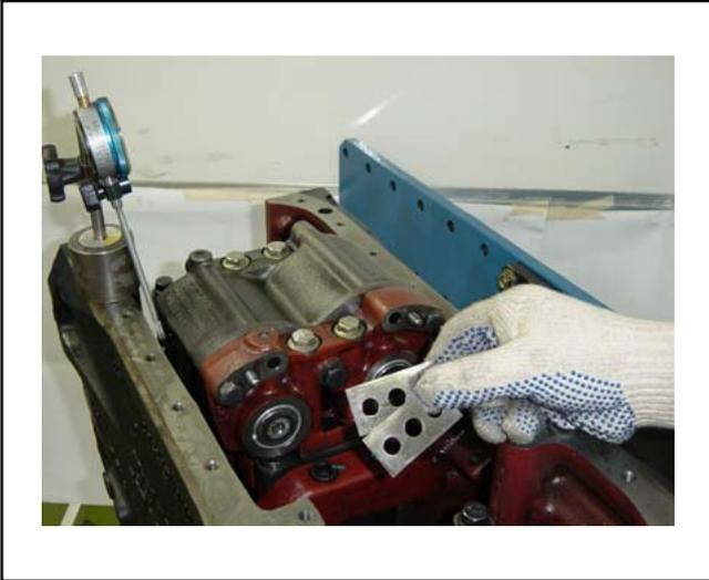
Caso no se obtenga el huelgo especificado, utilizar calzos de compensación y posicionarlos entre el compensador de masas y los cojinetes en que se encuentra montado.
