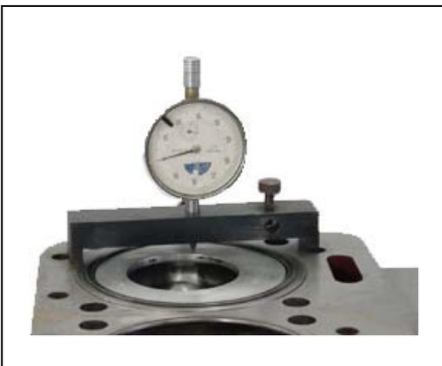
Con el pistón en PMS, medir la altura de la faz en relación a la faz del bloque. Conferir las posiciones de las saetas de los pistones, certificando de esta manera, se el montaje está correcta.
