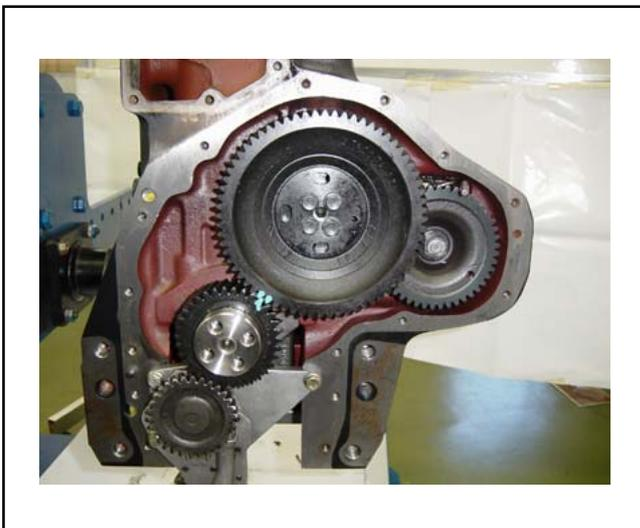
Instalar el engranaje del árbol de levas, observando la especificación de los tornillos.
