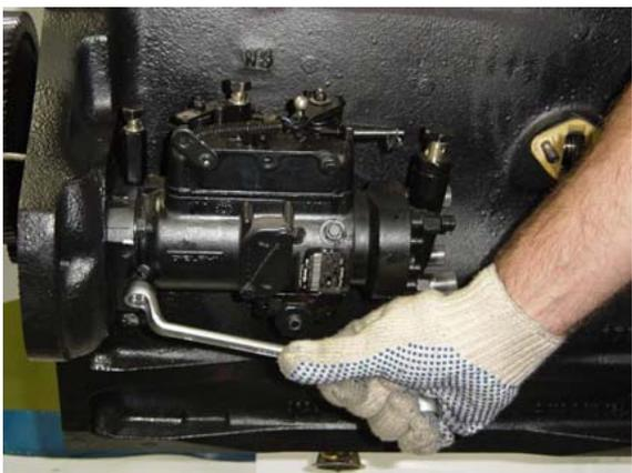
Después que los tornillos de los componentes de la carcasa de los engranajes están apretados, destrabar el eje de la bomba de inyección.
