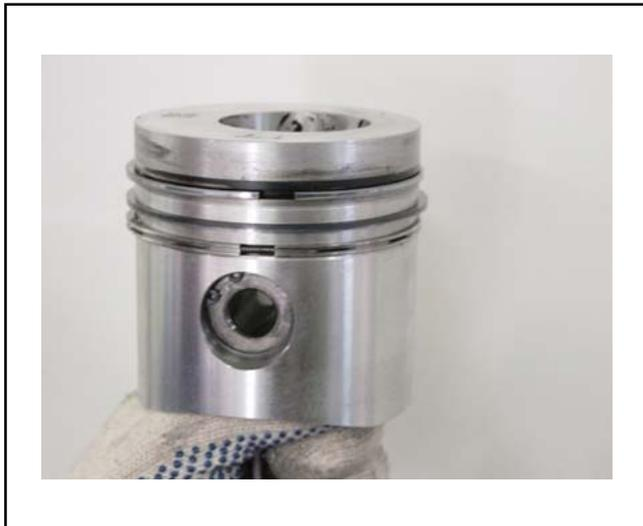
Antes de efectuar el montaje, es necesario lubricar y posicionar los anillos 180° entre si (entre puntas), diseccionando para el lado del perno del pistón.
