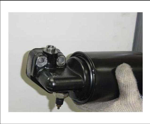
La figura indica la posición correcta del cuerpo de la válvula después del montaje.
