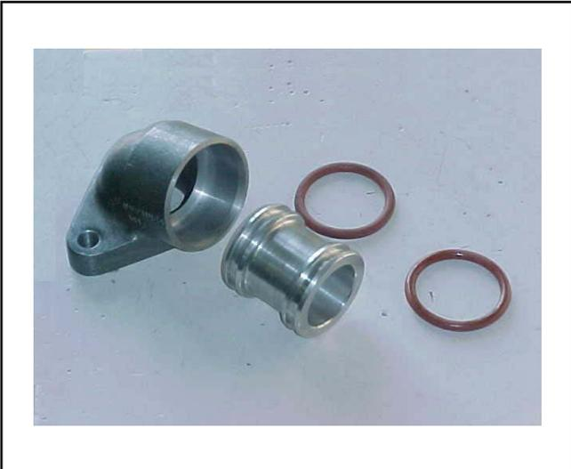
Montar la conexión en la curva de admisión con anillos nuevos. Aplicar una fina camada de vaselina para facilitar el montaje. Certificar que los anillos están montados en la posición correcta, pues puede causar pasaje de impurezas para la admisión.
