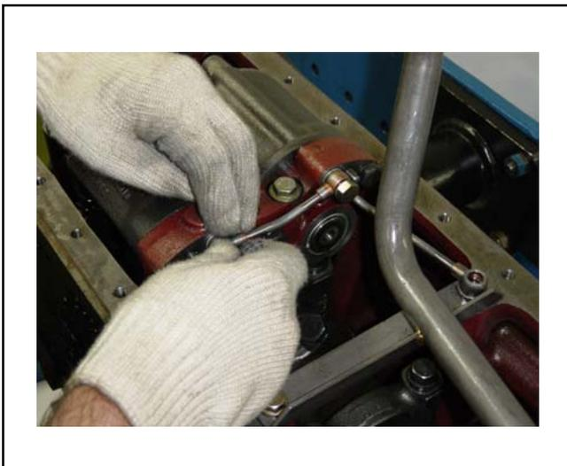
Instalar el tubo de lubricación del compensador de masas y aplicar el aprieto correspondiente.
