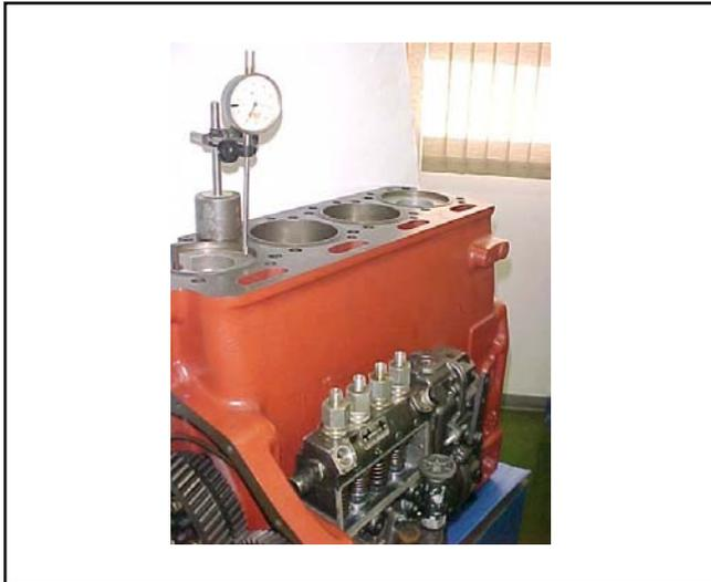
Instalar el reloj comparador sobre el pistón y bajar el pistón APMS virando el motor en el sentido siniestrogiro hasta poner en la altura correspondiente en los grados de la polea.
