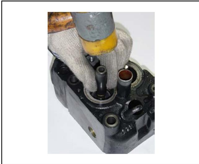
Utilizando la herramienta especial MWM No 9.610.0.690.15.4, finalizar la instalación de los retenes de las válvulas.
