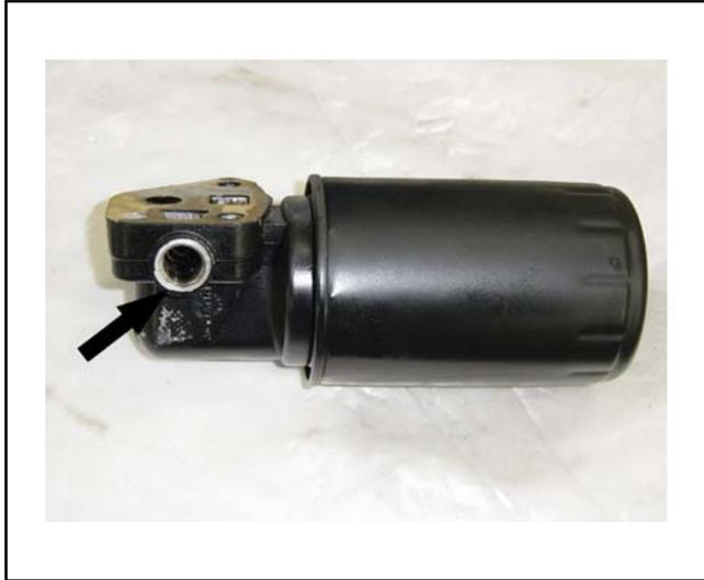
Esta válvula es proveída montada y basta instalarla en la culata del filtro de aceite.
