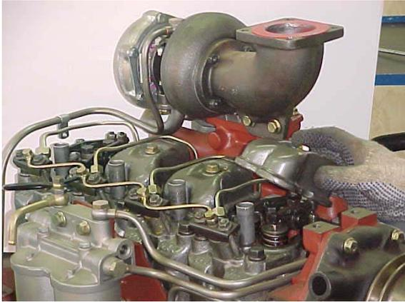
Girar el cigüeñal hasta posicionar las válvulas en balance (lado del volante) y tiempo de compresión (lado de la polea).
