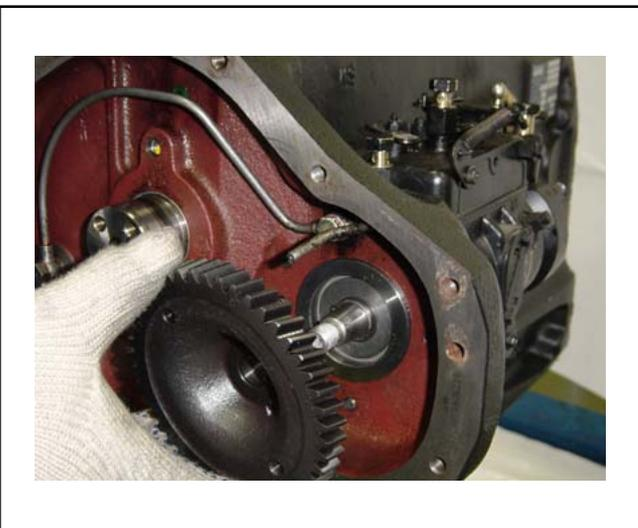
Instalar el engranaje de la bomba de inyección con **ATENCIÓN** para la posición de la chaveta.
