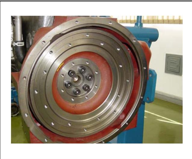
Con el volante trabado, soltar sus tornillos de fijación y sacarlo.
