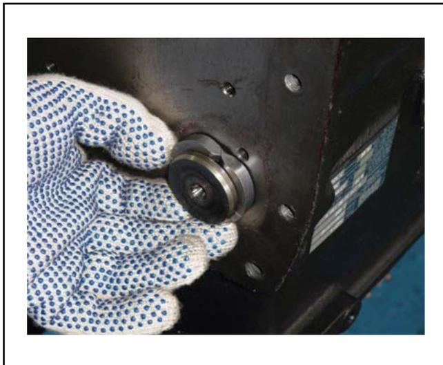
Con el árbol de llevas totalmente instalado, montar la traba y el anillo de vedamiento de acuerdo con el indicado en la figura.
