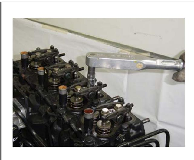
Después de la instalación, aplicar el aprieto especificado.
