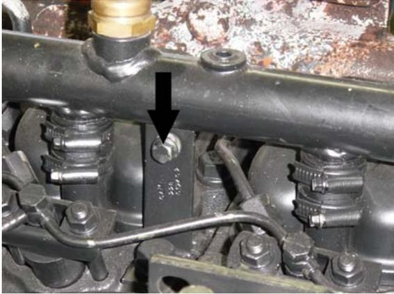
Sacar el tubo de agua, soltando todos los tornillos das abrazaderas, desconectando-o de las culatas.
