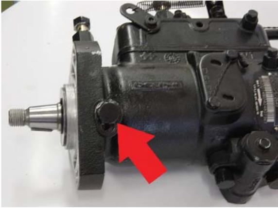
Aflojar el tornillo de trabamiento. En seguida, con auxilio del testador de toberas o aire comprimido, aplicar una presión de aire o combustible en la salida de la bomba que se conecta al tubo del 1º cilindro (lado de la polea).
