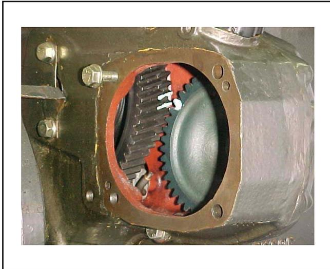
Con el 1º cilindro en compresión, es posible montar la bomba de inyección observando las marcas a través de la tapa de inspección.
