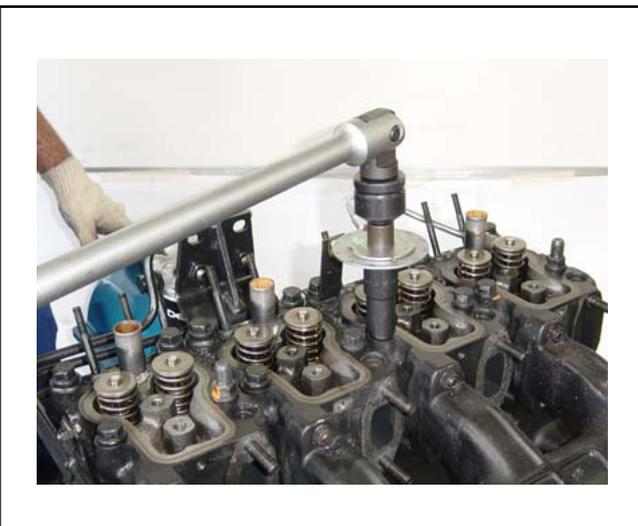
En seguida, aplicar el aprieto angular especificado utilizando el transferidor de ángulos.
