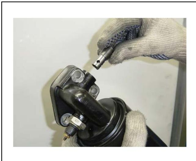
Montar primeramente el cuerpo de la válvula, apretando con  $\pm 10$  Nm. Esto garante el asentamiento del cuerpo de la válvula en el fondo de su alojamiento.
