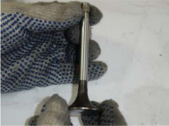
Instalar las válvulas en la culata.
