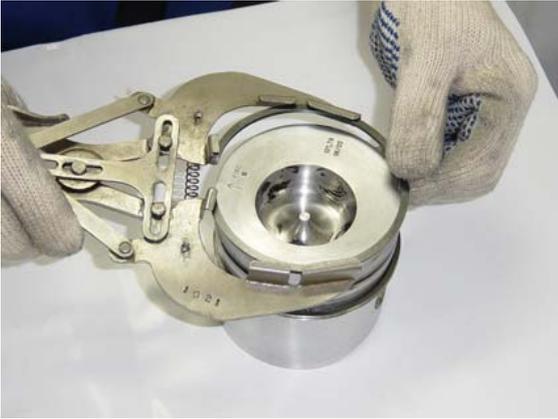
Montar los anillos en el pistón utilizando el dispositivo adecuado.
