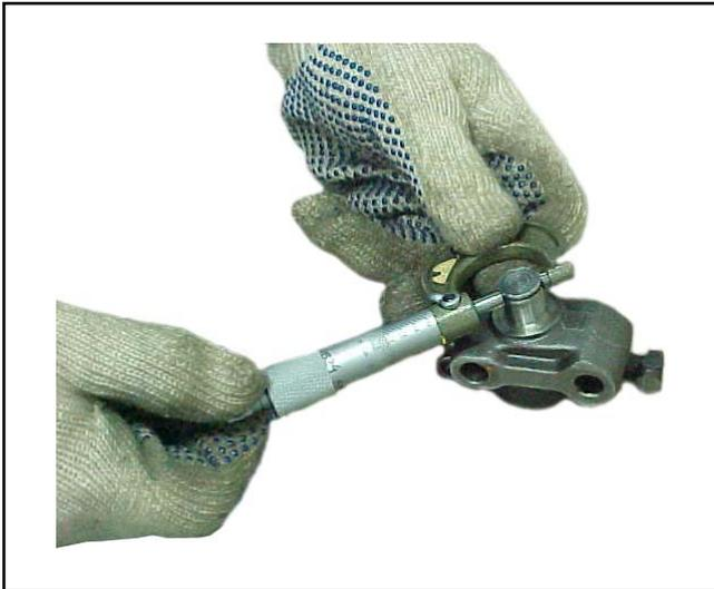
Medir el eje del balancín, ovalización y conicidad.
