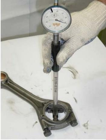
Posicionar el alesametro en los casquillos, "cerar" el reloj comparador en esta posición y, en seguida, soltar el tornillo (saeta) opuesto al guía. Medir la pret-tensión del casquillo.
