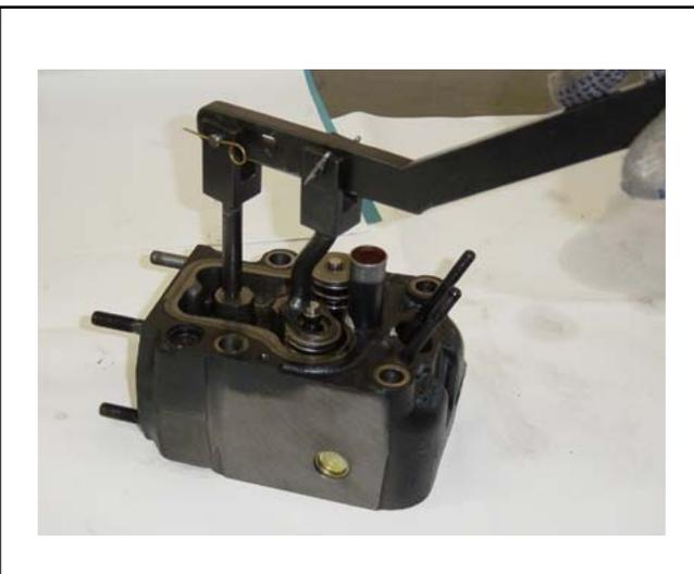
Utilizando la herramienta especial MWM No 9.407.0.690.044.6, se debe presionar los resortes, sacar los platos de los resortes, los resortes, el retén y, por fin, las válvulas.
