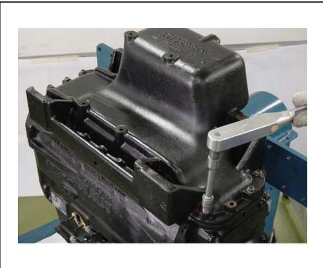
Instalar un empaque nuevo del cárter. El empaque debe ser montado sin la utilización de colas o adhesivos.
