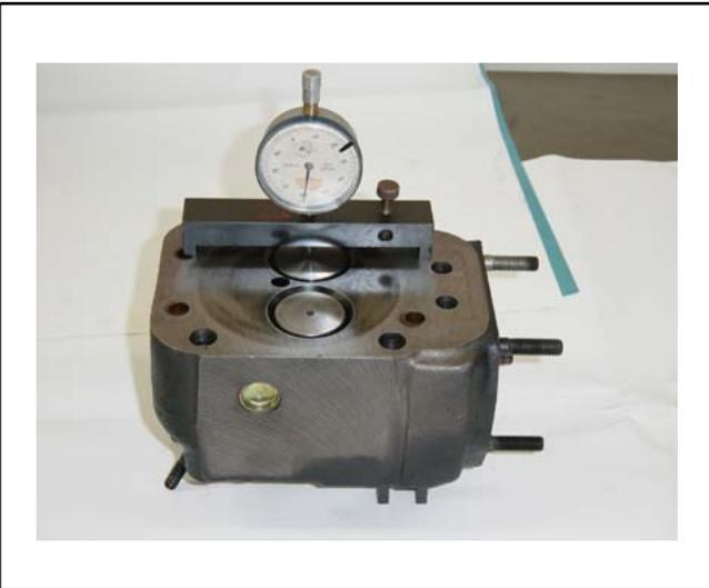
Medir la altura de la válvula en relación a la faz de la culata: 1,35 - 1,55 máx: 1,80mm.
