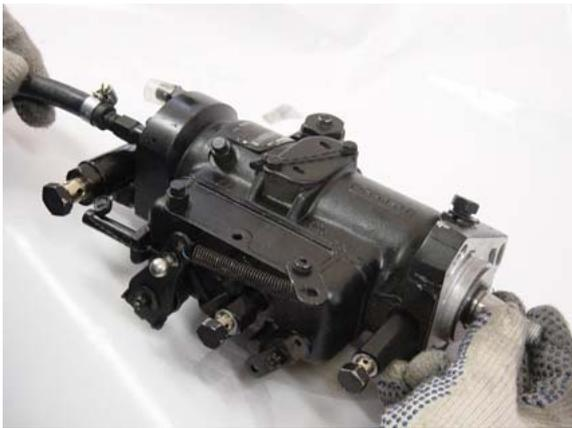
Simultáneamente, con la mano, girar el eje de la bomba de inyección en el sentido de giro hasta trabarlo. En este momento, se debe apretar el tornillo de trabamiento hasta que se trabe en el eje de la bomba de inyección.
