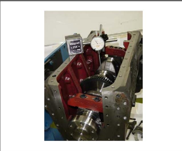
Con el cigüeñal en el bloque, montar una base magnética y un reloj comparador y medir el alabeo del cigüeñal.
