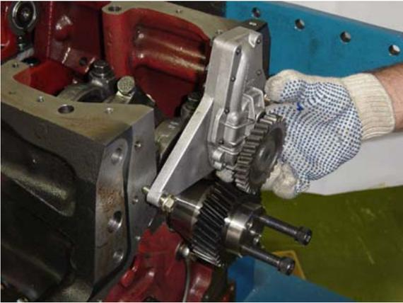
Instalar el reloj comparador posicionando-o sobre el diente del engranaje. Determinar el huelgo, moviendo la bomba arriba y para bajo hasta obtener el huelgo especificado y, en seguida, finalizar el aprieto de los tornillos.
