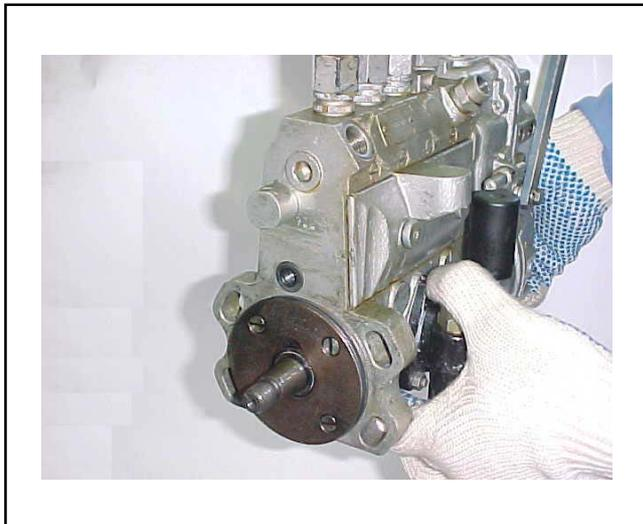
Antes de la instalación, cambiar el anillo de vedamiento de la bomba y examinar el agujero de retorno de aceite con relación a presencia de impurezas.
