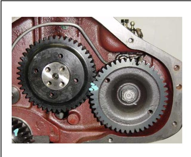
Instalar el engranaje intermedia de manera que las marcas con el engranaje de la bomba de inyección coincidan.
