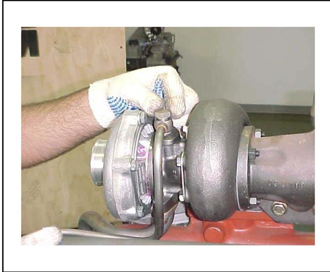
Montar el tubo de lubricación del turbo. Aplicar el aprieto especificado en ambas las extremidades.
