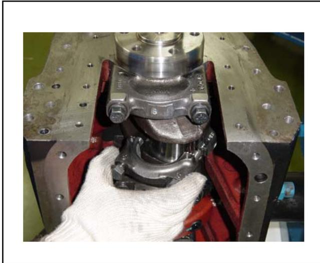
Al instalar la tapa de la biela, los agujeros deben estar direccionados para el lado del volante.
