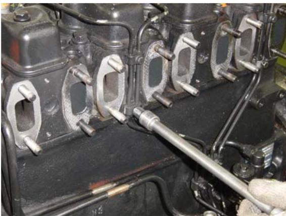
Após soltar todos os pontos de fixação, remover os tubos de alta pressão.
