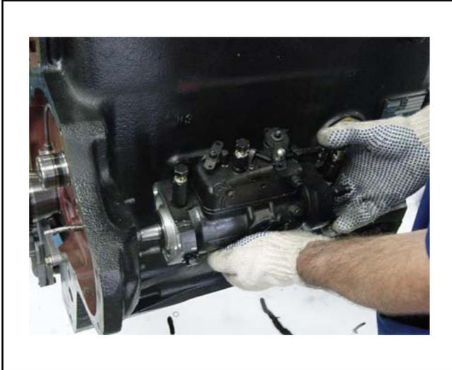
Sacar la bomba de inyección soltando las tuercas que fijan la bomba en la carcasa de los engranajes.
