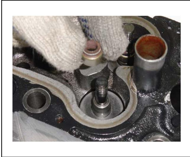
Instalar los retenes de las válvulas en los guías.
