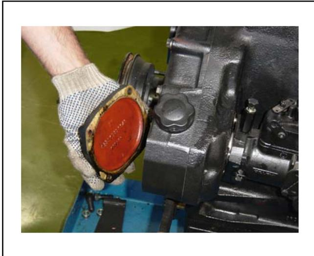
Instalar la tapa de la carcasa de los engranajes y aplicar el aprieto especificado en los tornillos.
