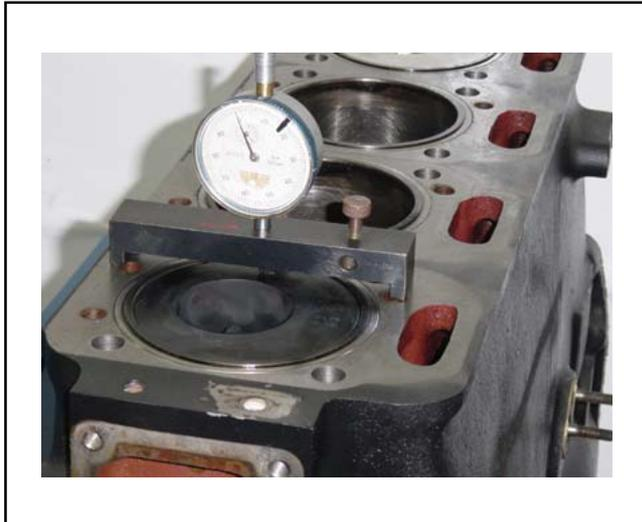
Instalar un reloj comparador sobre el pistón (lado polea) en compresión y, moviendo el cigüeñal, encontrar el PMS.
