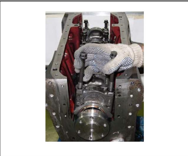
Sacar los cojinetes utilizando los propios tornillos de fijación, de acuerdo con el indicado en la figura.
