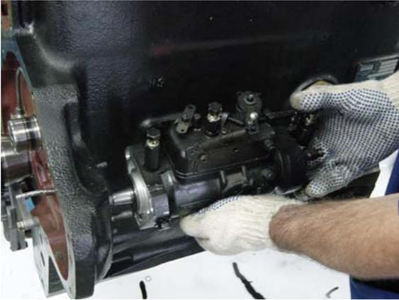
Instalar la bomba de inyección en el motor, posicionando-a en el centro y apretándola con el aprieto especificado.
