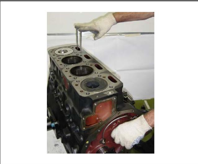
Otra manera para el montaje del engranaje es posicionar dos varillas de válvulas en el cilindro lado del volante y mover el árbol de levas con la mano hasta que las varillas estén en balance.
