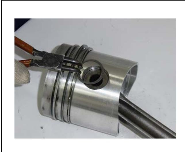
Instalar el anillo traba con **ATENCIÓN**, pues el lado plano del anillo debe estar vuelto para fuera.
