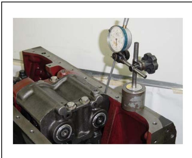
Sacar la herramienta especial y, utilizando un reloj comparador, medir el huelgo existente
