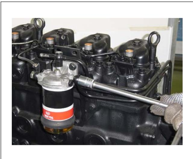
Instalar los tubos de baja presión, aplicando aprieto especificado en seguida.
