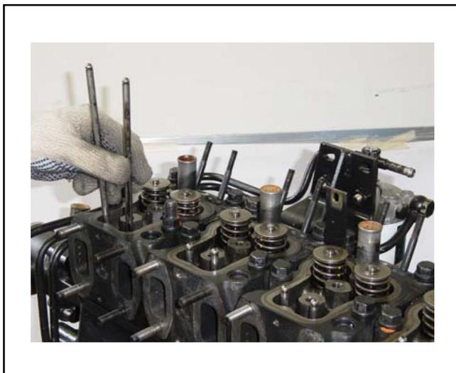
Después de la verificación, instalar los cuerpos de los balancines en las culatas.
