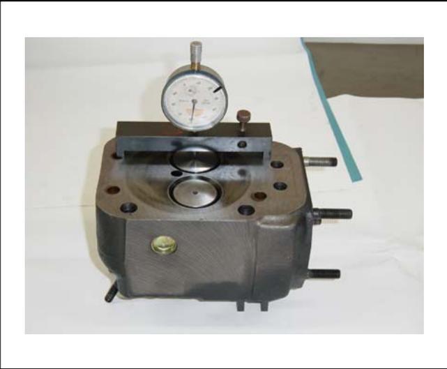
Después del montaje de la culata, conferir la altura de las válvulas en relación a la faz plana de la culata.
