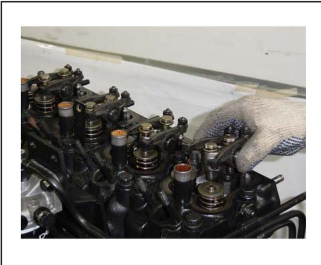
Después del análisis dimensional, montar el conjunto de los balancines y instalarlos en el motor.
