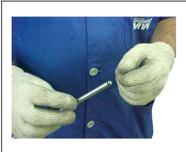
Inspeccionar los cuerpos de los balancines. Las puntas de los cuerpos no pueden estar sueltas o trincadas. Verificar se no hay desgaste excesivo y se el agujero de lubricación no está obstruido. Verificar también se los cuerpos no están alabeados.
