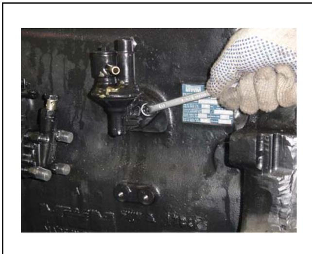
Instalar la bomba de combustible y apretar sus tornillos con el aprieto especificado.
