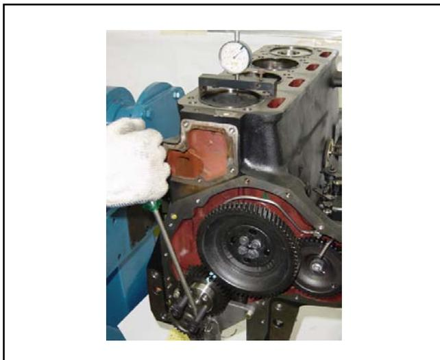
Adelante, mover el cigüeñal APMS hasta posicionar el pistón correspondiente en los respectivos grados indicados en la plaqueta de identificación del motor.
