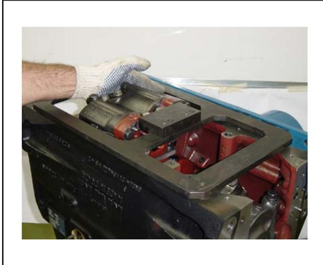
Encostar el compensador de masas en la regla y, al mismo tiempo, moverlo en dirección a la bomba de inyección.
