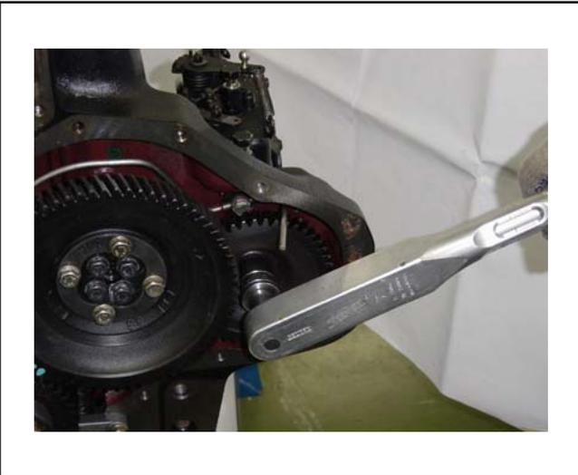
Apretar en la tuerca del eje de la bomba de inyección.
