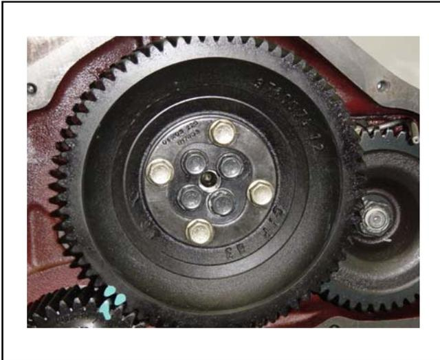
Antes de efectuar el aprieto final de los tornillos, se debe observar se la clasificación de los tornillos está correcta:
