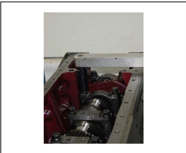
Después de la medida del huelgo axial, montar los demás cojinetes apretando de acuerdo con el procedimiento descrito anteriormente.
