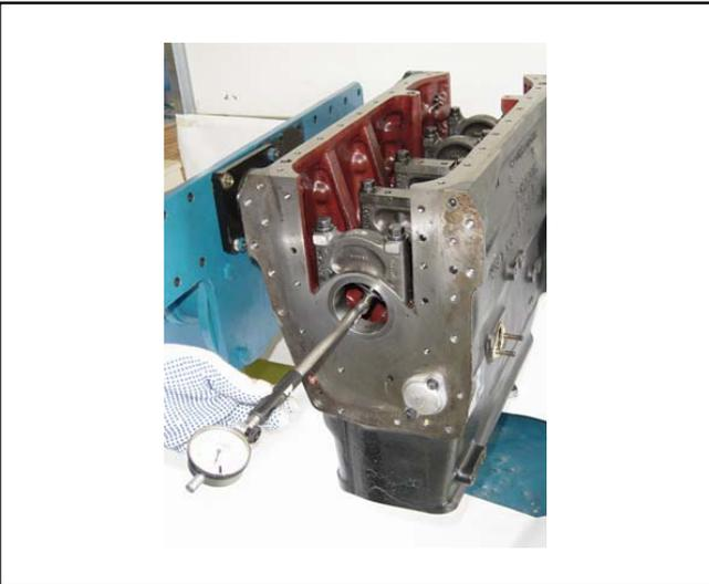
Montar las tapas de los cojinetes sin los casquillos y aplicando aprieto especificado. Utilizando un alesametro, efectuar las mediciones de diámetro, ovalización y conicidad. Después de las mediciones, sacar las tapas de los cojinetes.
