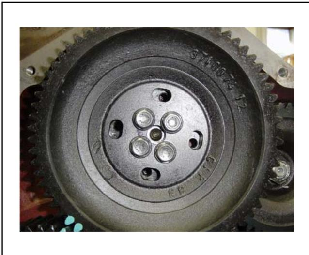
En este momento, con el motor posicionado en APMS, los agujeros coinciden y ya es posible finalizar el montaje de los componentes de la carcasa de los engranajes.
