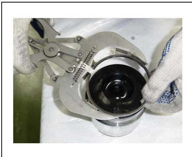
Sacar los anillos del pistón utilizando el dispositivo adecuado.
