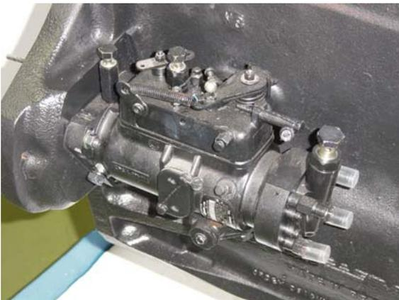
Posición final de la bomba de inyección después de estar instalada.
