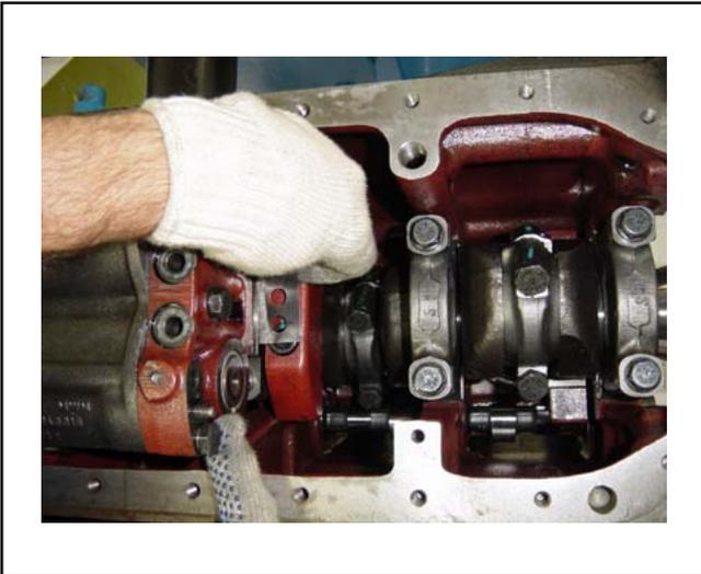
Instalar los calzos de compensación de acuerdo con el necesario y repetir las operaciones anteriores.
