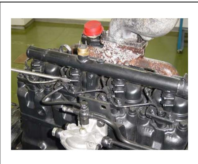
Remover o tubo d'água, soltando todos os parafusos das braçadeiras e desconectando-o do cabeçote.
