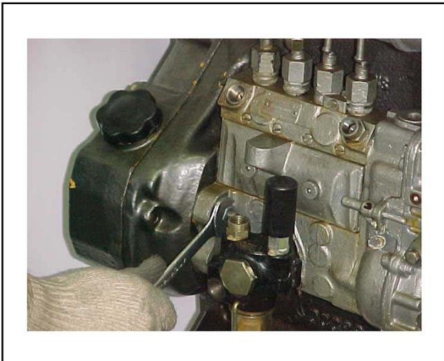
Soltar las tuercas de fijación de la bomba de inyección.
