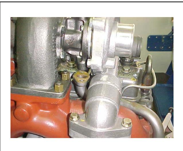
Montar el tubo de retorno en la parte inferior del turboalimentador con empaque nuevo y aplicar el aprieto especificado.
