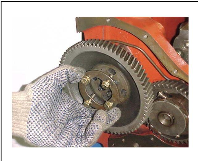
Encostar la arandela y los tornillos de apoyo del engranaje para facilitar el ajuste de sincronismo.
