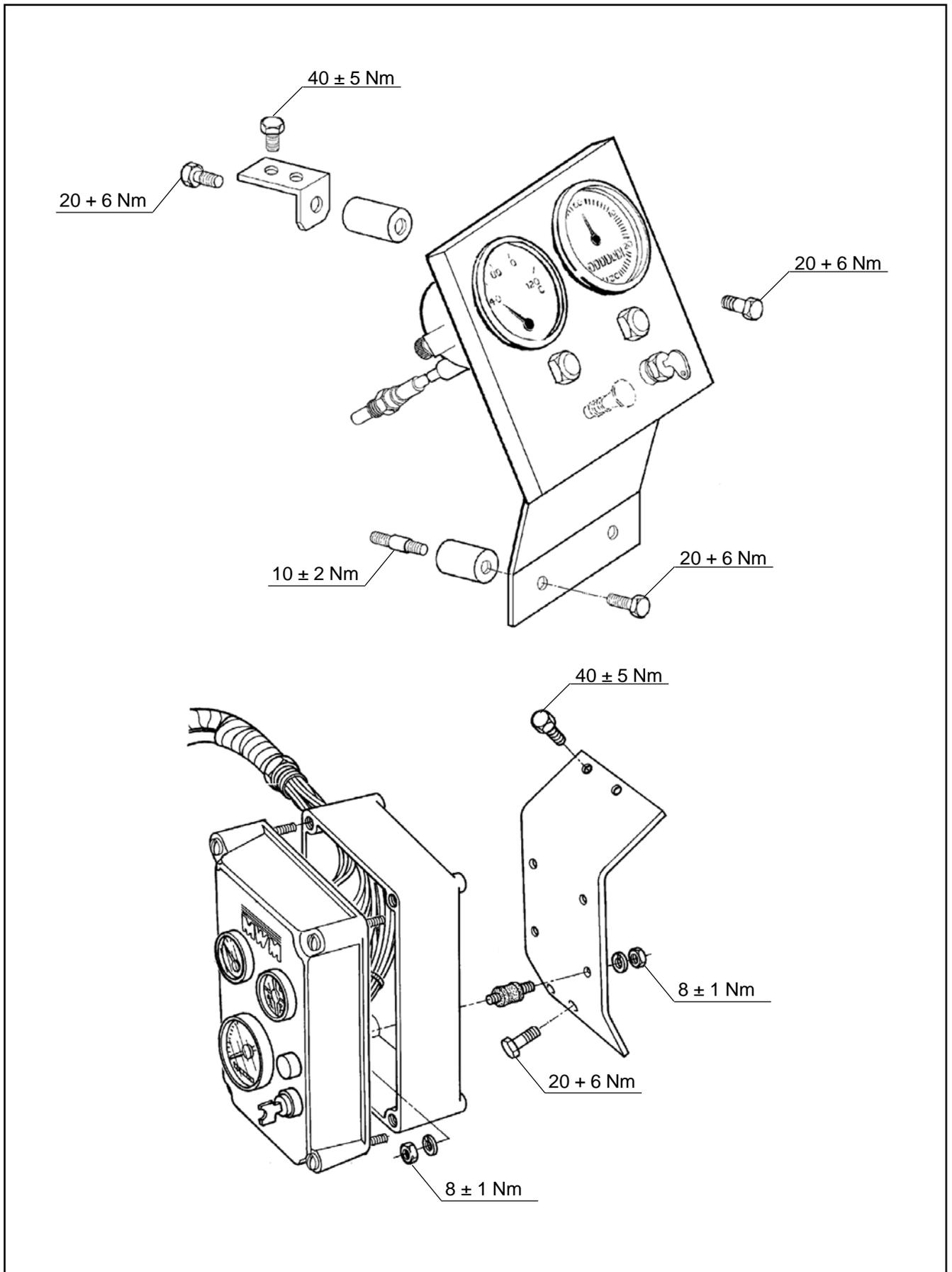
Especificação do Torque de Aperto dos Parafusos
