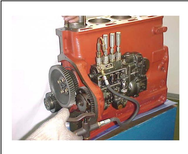
Instalar la bomba de punto y fechar las otras salidas y retorno de la bomba de inyección.
