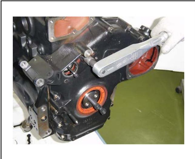
Instalar los tornillos de la carcasa de los engranajes y aplicar el aprieto correspondiente.
