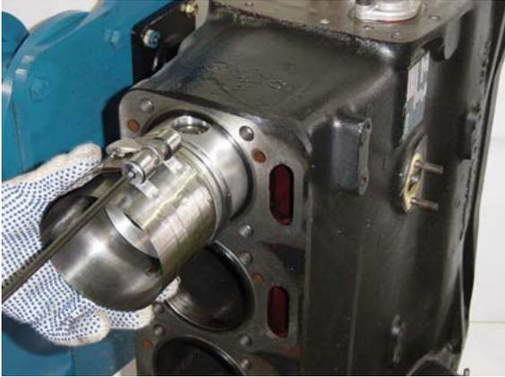
Con los anillos prensados, empujar el pistón cuidadosamente para que los anillos no sufran interferencia y rompan.
