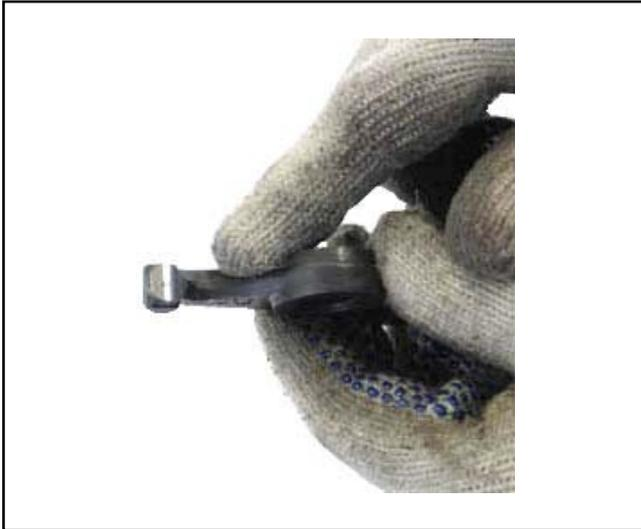
Verificar se los martillos del balancín no presentan desgaste excesivo o trincas en el alojamiento del eje o en la región de contacto con el cuerpo de la válvula. Al sacar los balancines, observar se no hay señales de desgastes.
