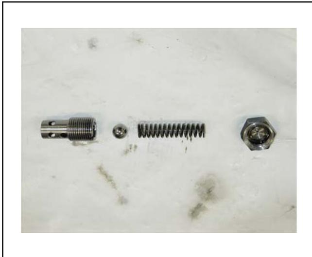
Desmontar la válvula de acuerdo con el indicado en la figura.
