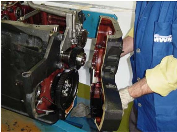
Soltar los tornillos 10.9 y 8.8 y sacar el engranaje del árbol de levas, engranaje intermedia y demás engranajes.
