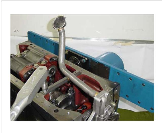
Aplicar el aprieto especificado en los tornillos del tubo de succión de aceite.
