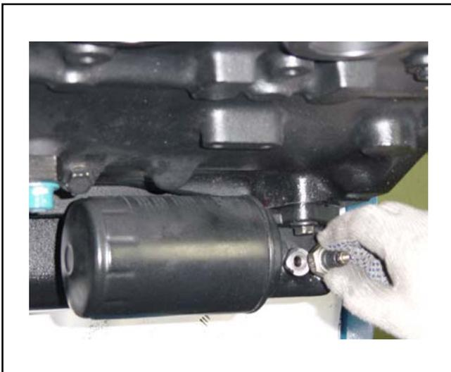
Instalar el sensor del filtro de aceite y aplicar aprieto especificado.
