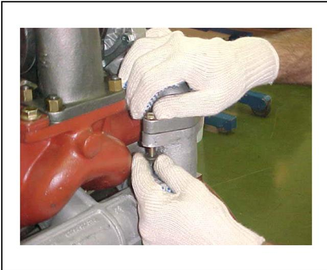
Después de la tuerca obtener apoyo adecuado, aplicar el aprieto especificado en el tornillo.
