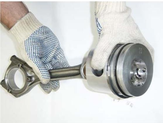
En el montaje del pistón en la biela, la marca característica (saeta) estampada en la cabeza del pistón debe, obligatoriamente, estar direccionada en el sentido de los tres agujeros existentes en la biela, de acuerdo con el indicado en la figura.
