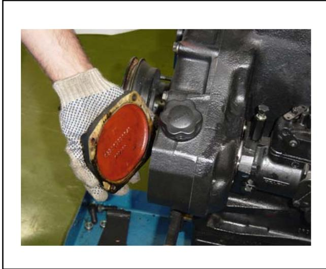
Instalar la tapa de la carcasa de los engranajes y aplicar o aprieto especificado en los tornillos.
