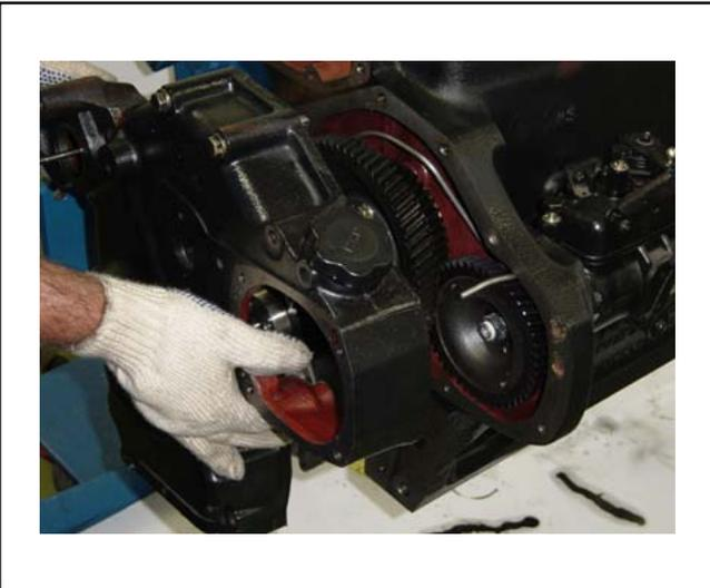
Con todos los componentes periféricos de la región de la carcasa de los engranajes removidos, soltar los tornillos y sacar la carcasa de los engranajes.
