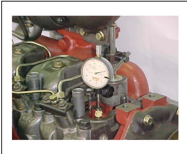
El punto de inyección del motor debe ser efectuado con el reloj comparador midiendo el desplazamiento del pistón correspondiente a los grados en la polea (ver tabla).
