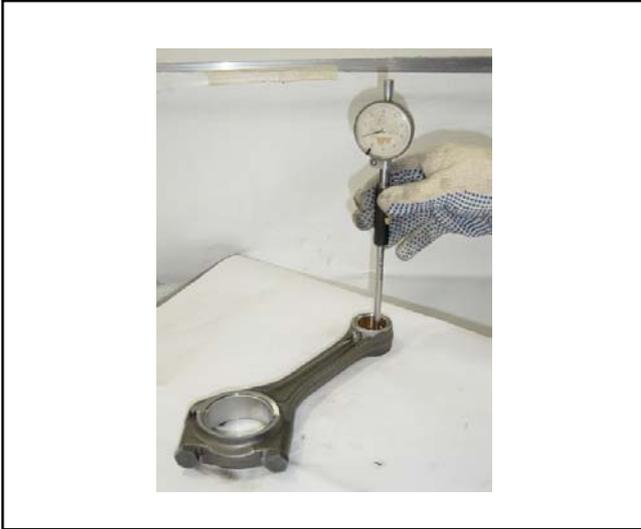
Medir el diámetro del buje de la biela observando cuanto a desgastes y ovalizaciones.
