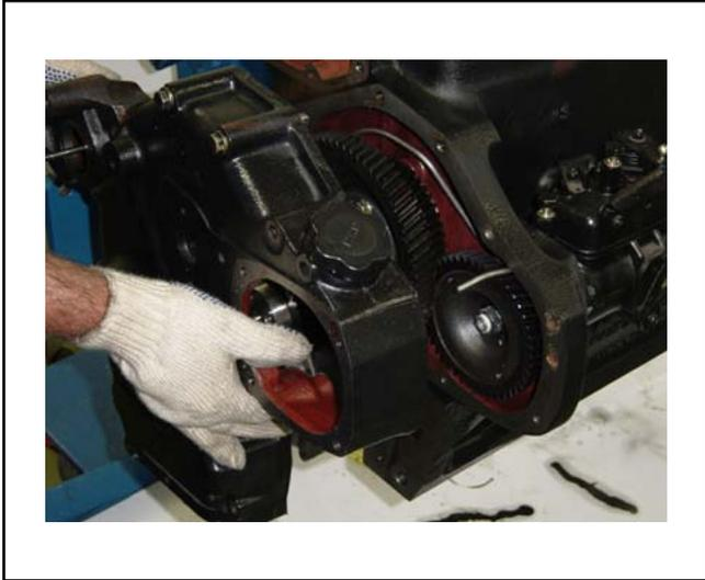
Instalar la tapa y empaque de la carcasa de los engranajes.
