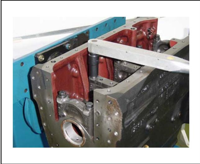
Después de instalar todos los cojinetes con los respectivos casquillos, aplicar aprieto especificado para efectuar la medición del huelgo radial.
