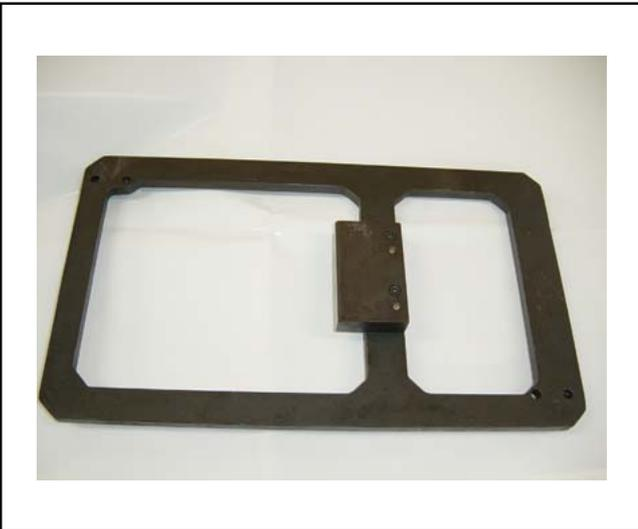
Para un perfecto alineamiento del compensador de masas, se debe utilizar la herramienta especial MWM No 9.0690.73.2.9315.
