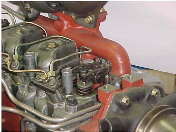
Soltar la tuerca del engranaje de la bomba de inyección.
