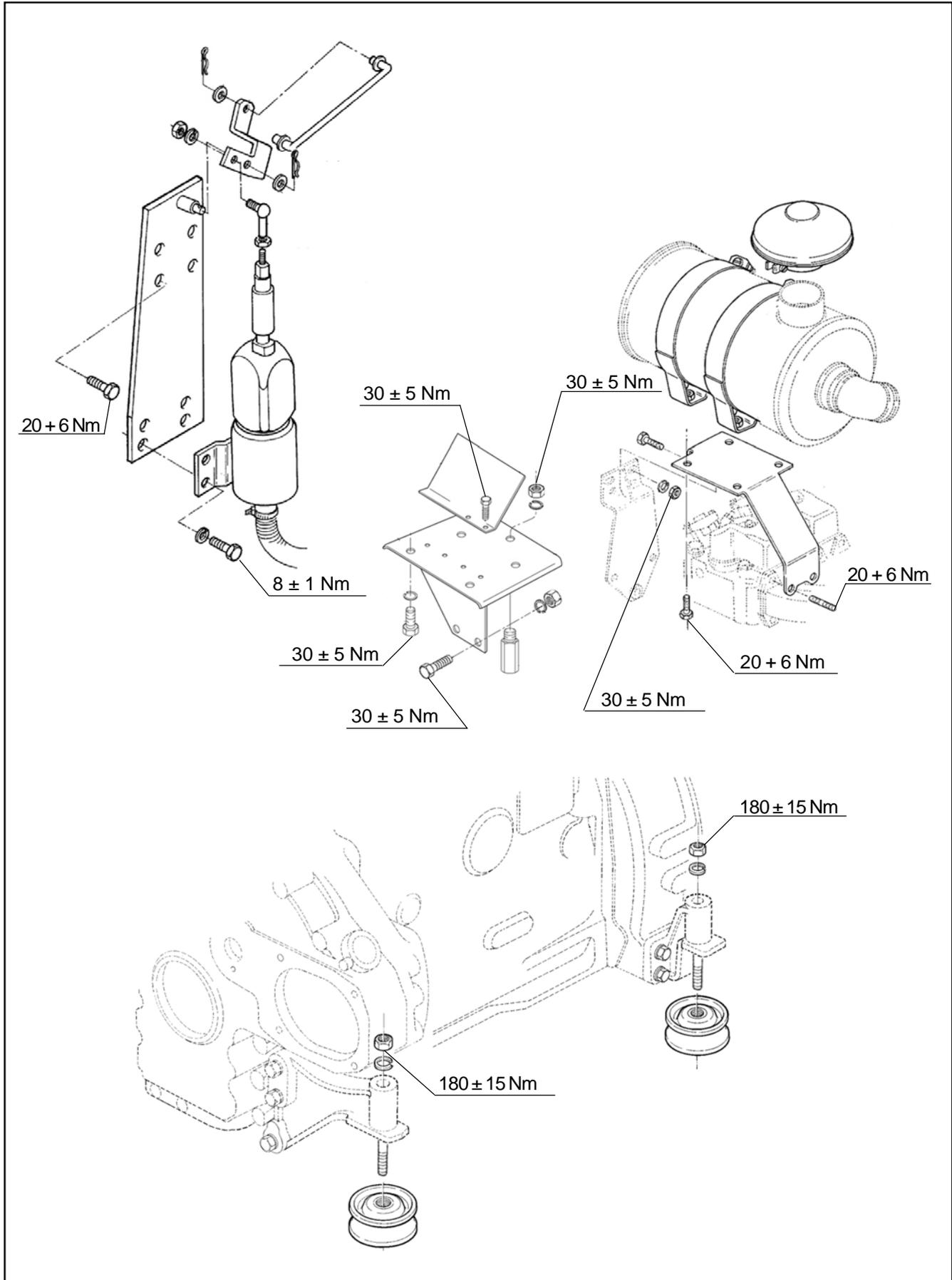
Especificação do Torque de Aperto dos Parafusos - Bomba Manual
