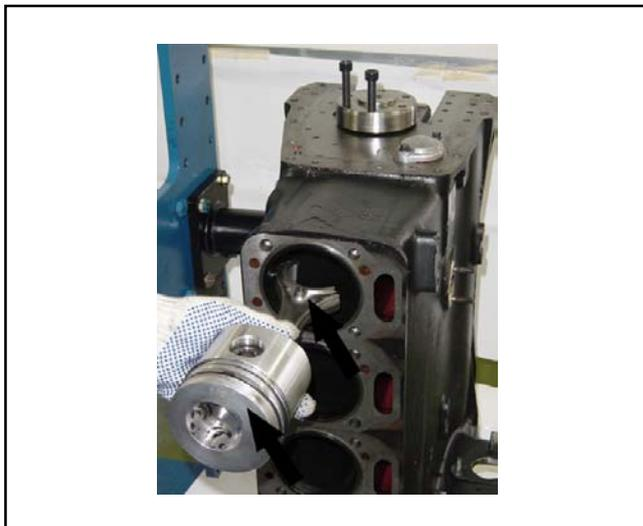
Al instalar el conjunto pistón/biela, observar atentamente para que la marca estampada en la cabeza del pistón y el agujero de la biela estén direccionados para el lado del volante, de acuerdo con el destacado por las saetas en la figura.
