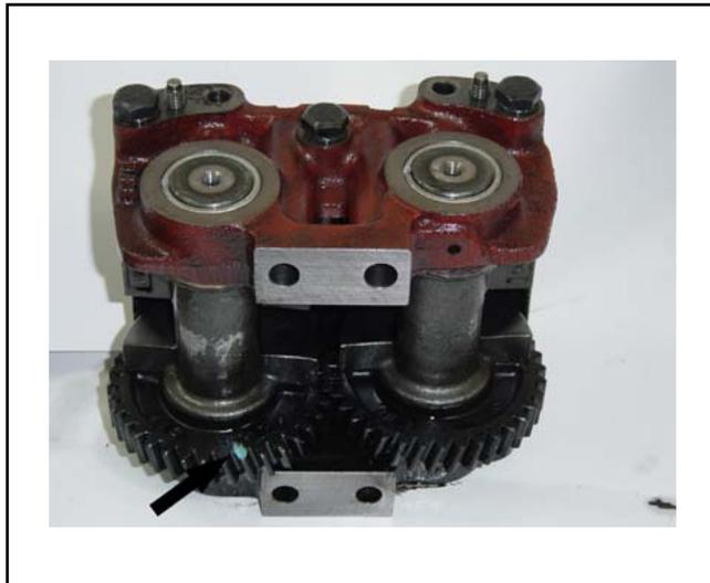
El compensador de masas posee una marca en el engranaje de accionamiento que, en la instalación, debe coincidir con la marca existente en la cremallera del cigüeñal, de acuerdo con que puede ser observado en la saeta de la figura.
