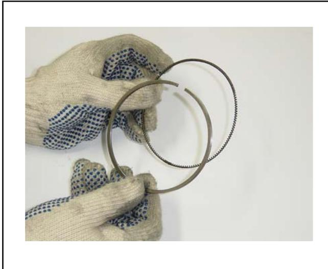
Anillos a ser instalados en el pistón.
