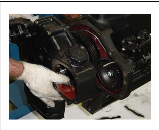
Instalar el empaque y la carcasa de los engranajes.
