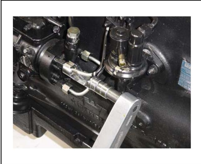
Apretar los tubos de alta presión en las conexiones con la bomba de inyección y toberas.
