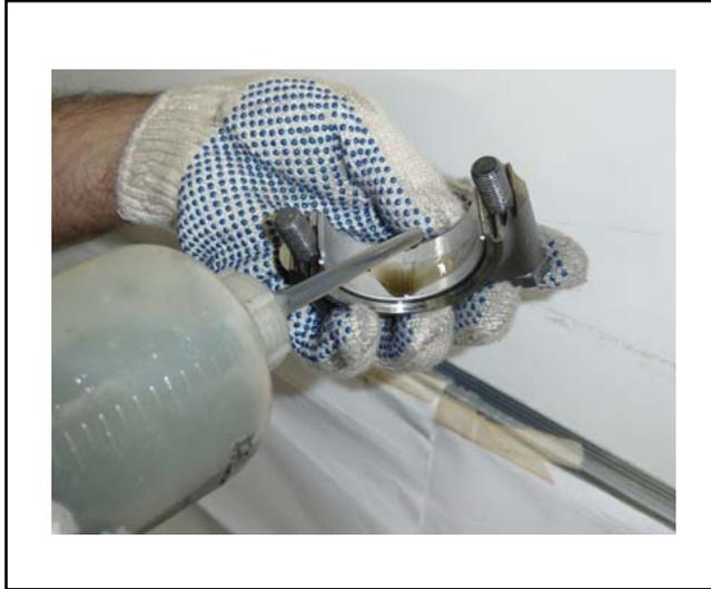
Lubricar los casquillos de la tapa de la biela y instalarlas observando siempre la posición del guía.
