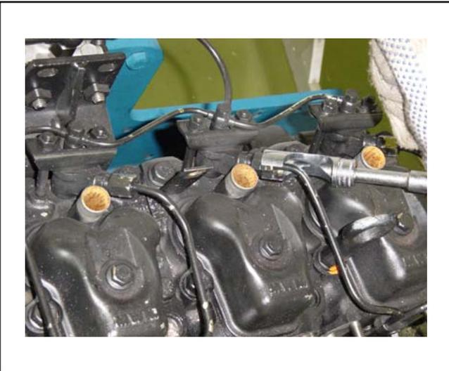
Con las toberas sueltas, efectuar el montaje de los tubos de alta presión.
