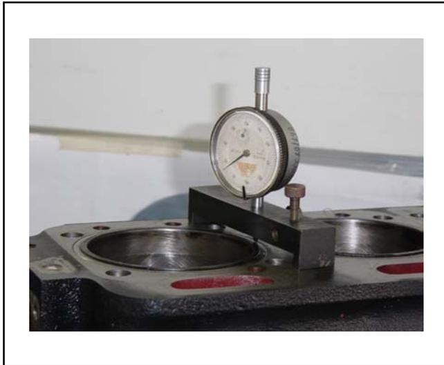
Instalar primeramente las camisas sin los anillos de vedamiento, para entonces efectuar la medición de la saliencia de la camisa en relación a la faz superior del bloque utilizando la herramienta especial MWM no 9.407.0.690.031.6, con el reloj comparador instalado.
