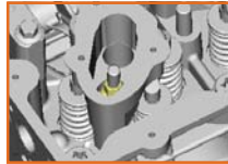
Fijación del adaptador del inyector
