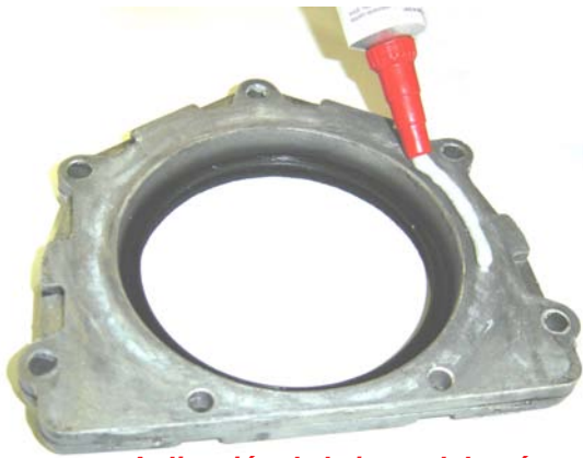
Aplicación de la junta del retén trasero
