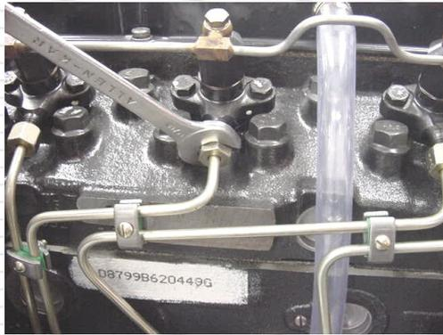
Aflojar las tuercas de los picos inyectores para efectuar el purgado del sistema de alta presión de combustible.
