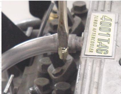
Retire la manguera de respiro del motor soltando la abrazadera de fijación.
