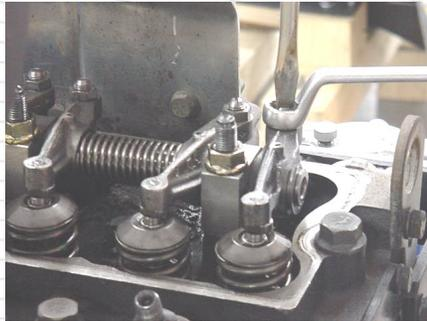
Con el motor en PMS y el 1° cilindro en balanceo regular las válvulas del 4° cilindro.
