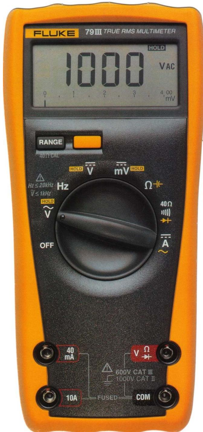
Los orificios para colocar las clavijas están perfectamente identificados. Hay uno para colocar la clavija común a todas las mediciones (COM). Otro que se usa para medir tensión, resistencia y continuidad. Los dos de la izquierda son para medir corriente, uno hasta 40 mA y el otro hasta 10A.
