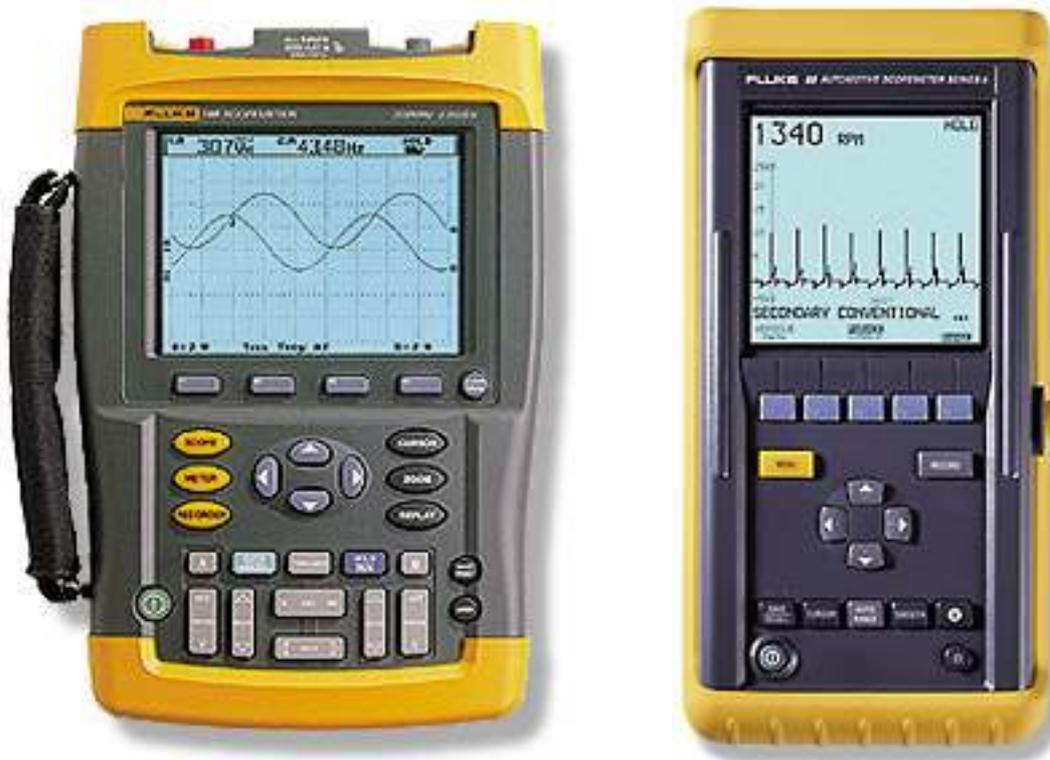
Las fotos muestran dos modelos FLUKE de osciloscopios de mano de última generación, el de la izquierda es para aplicaciones en electrónica, y el de la derecha para aplicaciones en el ámbito automotor.
