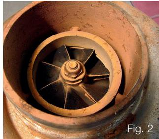
Entrada de abrasivo que desgastó el rotor y la carcasa. (Fig. 2)
